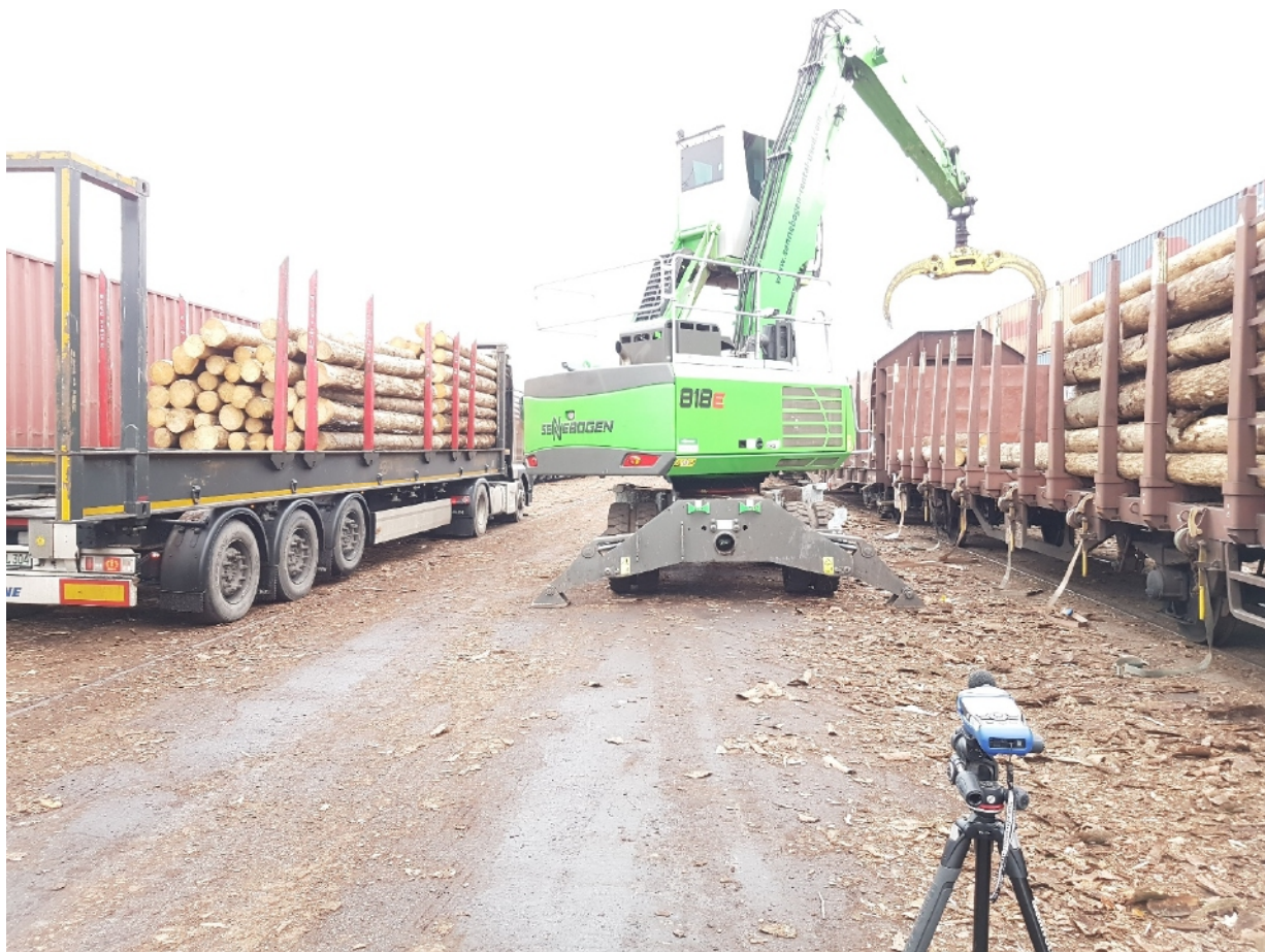
Abbildung 21: Messung Umschlaggerät Bagger Sennebogen 818E (Messg. "Rundholz_SLM_001")
