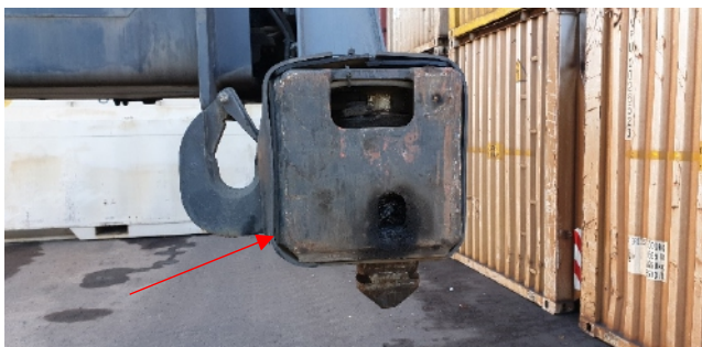
Abbildung 18: Greiferende mit Elastomerstreifen
